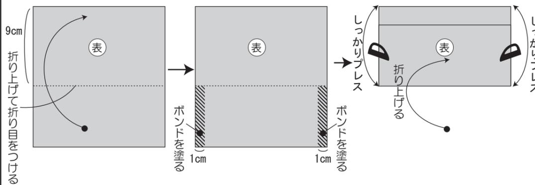
④ 布を③で接着した形のまま、裏返します。レースの裏にボンドを塗って図の位置にアイロンで接着します。(※後で左右1cmずつ内側に折り込むので、バランスを考えてレースを取り付けましょう) 布を開いてから、左右両端1cmずつ内側に折り、アイロンで折り目をつけて開きます。
