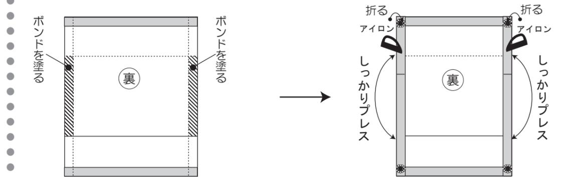
⑥ 下図の斜線の部分にボンドを塗ります。四隅の部分は特にしっかりと塗ってください。上下を折り目どおりに折ってから、左右両端とケースの後ろ側をしっかりとプレスして接着します。
