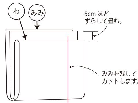
②カッティングマットの方眼を利用して、カットしたい幅に切っていきます。布のみみの部分は2~3cm切らずに残します。全部カットして広げると、図のようになります。
