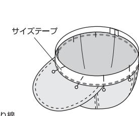
ブリムのサイズ元（頭回り）の縫いしろにサイズテープを重ね、出来上がり線に合わせて待針で止める。サイズテープのきわみにミシンをかける。
