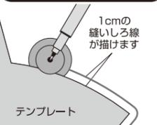
側面の溝にテンプレートをはさみます。
